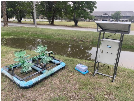
รูป 3.6 การประกอบชิ้นงานเครื่องตรวจวัดคุณภาพน้ำและเติมอากาศโดยใช้กังหันน้ำที่สมบูรณ์
