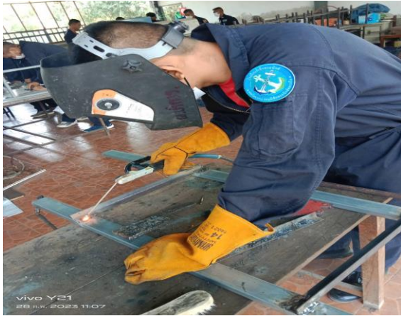
รูป 3.3 การตัดเหล็กและเชื่อมเหล็กในการออกแบบชิ้นงาน
