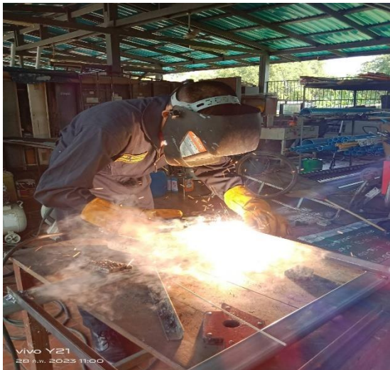
รูป 3.4 การเชื่อมเหล็กในการออกแบบชิ้นงาน
