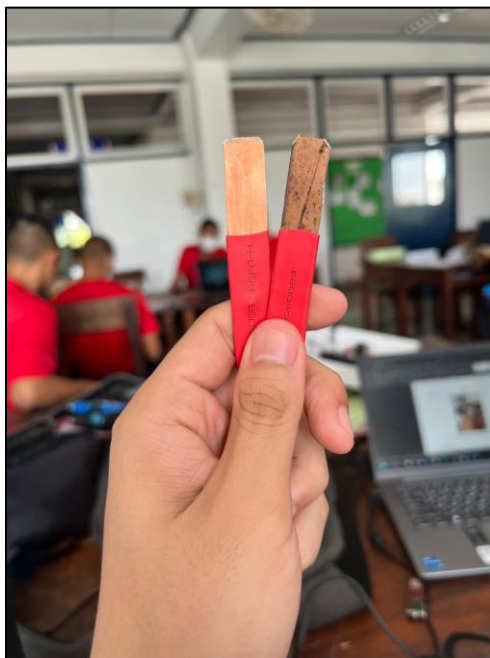
รูปที่ 3.6 สายของ Sensor วัดระดับน้ำและตรวจจับไฟรั่ว
