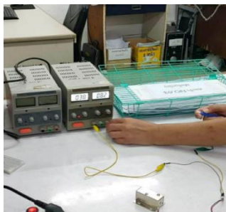
รูปที่ 2.7.2 ตรวจสอบกลอนไฟฟ้า
