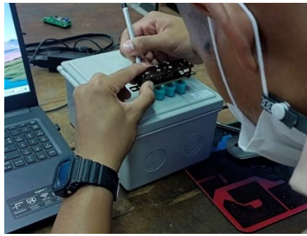
รูปที่ 3.7 นำแผงวงจรมาประกอบเข้ากับกล่องใสอุปกรณ์
