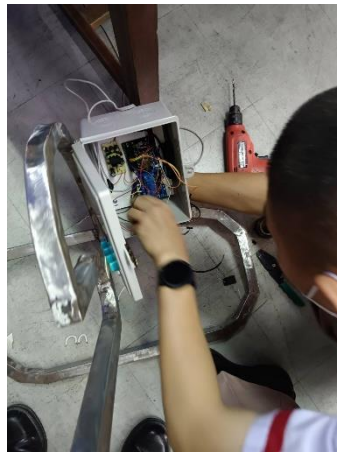
รูปที่ 3.8 นำกล่องอุปกรณ์ไปติดตั้งกับพัดลม
