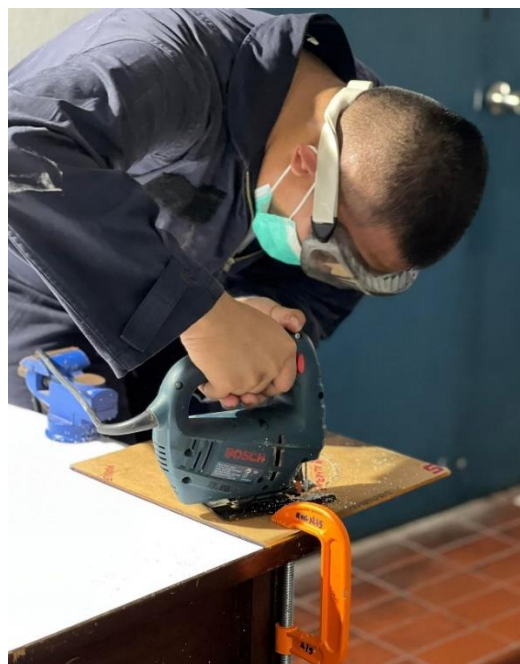
รูปที่ 6.2.4 ตัดแผ่นอลูมิเนียม
