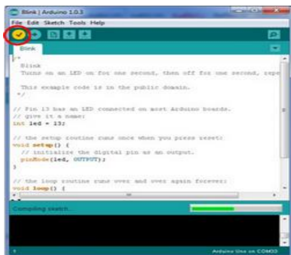
รูปที่ 5 กดปุ่ม Verify เพื่อตรวจสอบความถูกต้อง และ Compile โค้ดโปรแกรม
