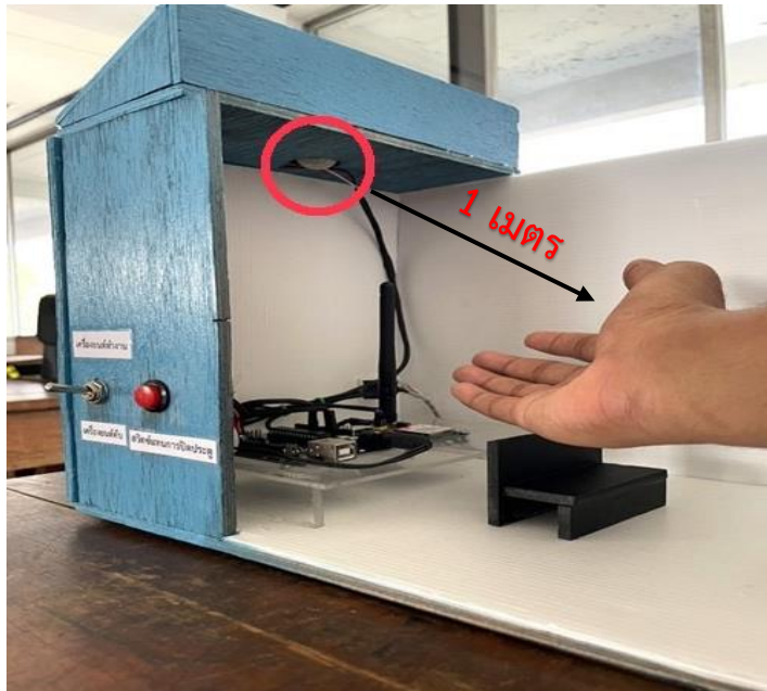
รูปที่ 4.1 ตรวจสอบระยะที่ 1 เมตร
