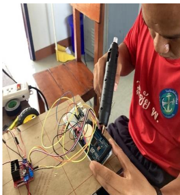
รูปภาพที่ 3.2.5 ติดตั้งตัวบอร์ด Arduino Mega 2560
