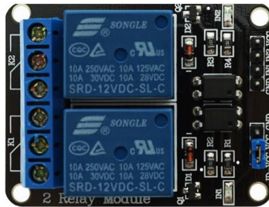
รูปภาพที่ 2.6 Relay Module 2 Channel
