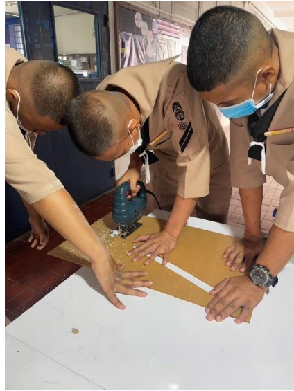
ภาพที่ 3.4 การตัดแผ่นอะคริลิก
