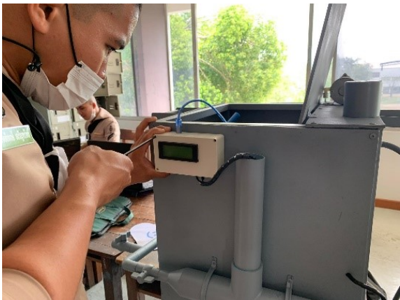
รูปที่ 3.11 ประกอบเซนเซอร์เข้ากับถังเก็บน้ำ
