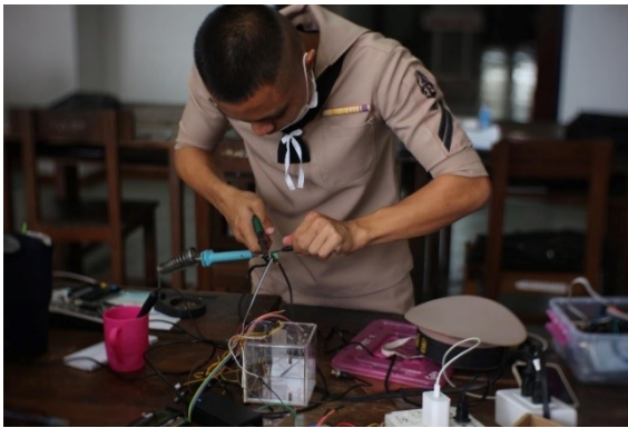
รูปที่ 3.3 การตัดต่อสายไฟ
