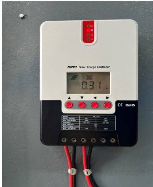
รูปภาพที่ 3.6 ทดสอบการชาร์จไฟเข้าสู่แบตเตอรี่
