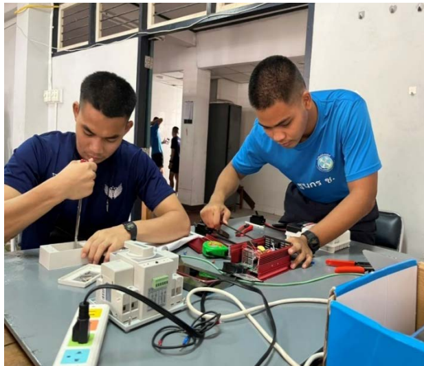
รูปภาพที่ 3.4.2.2 การประกอบแผง “ชุดสาธิตระบบโซลาร์เซลล์”
