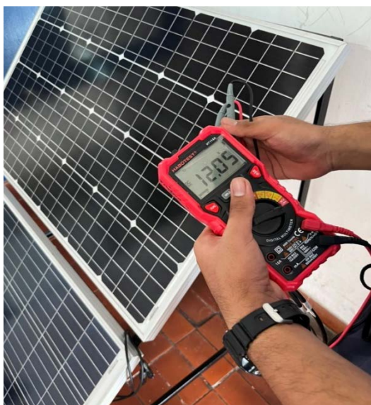
รูปภาพที่ 3.5 ทดสอบการทำงานของแผงโซลาร์เซลล์
