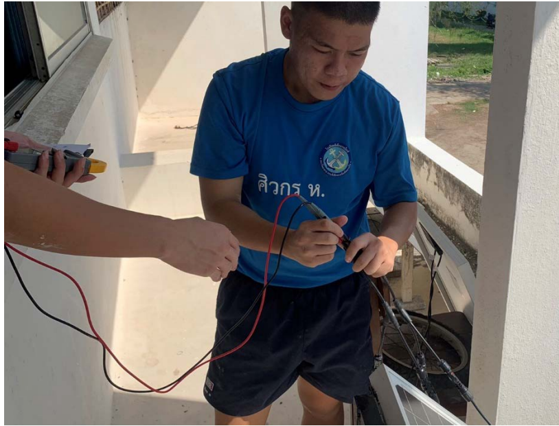
รูปภาพที่ 3.4.3.4 ทดสอบการวัดแรงดันไฟฟ้า
