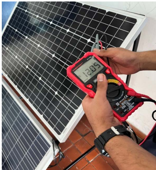
รูปภาพที่ 3.4.3.1 ทดสอบการทำงานของแผงโซลาร์เซลล์
