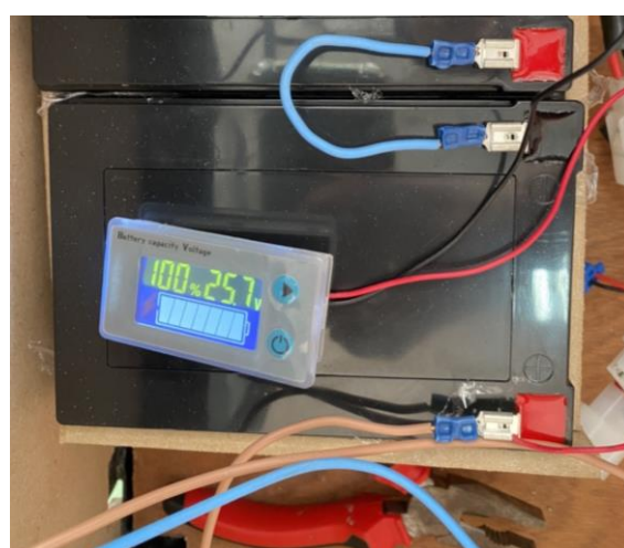
รูปที่ 3.11 ทดสอบความจุของแบตเตอรี่
