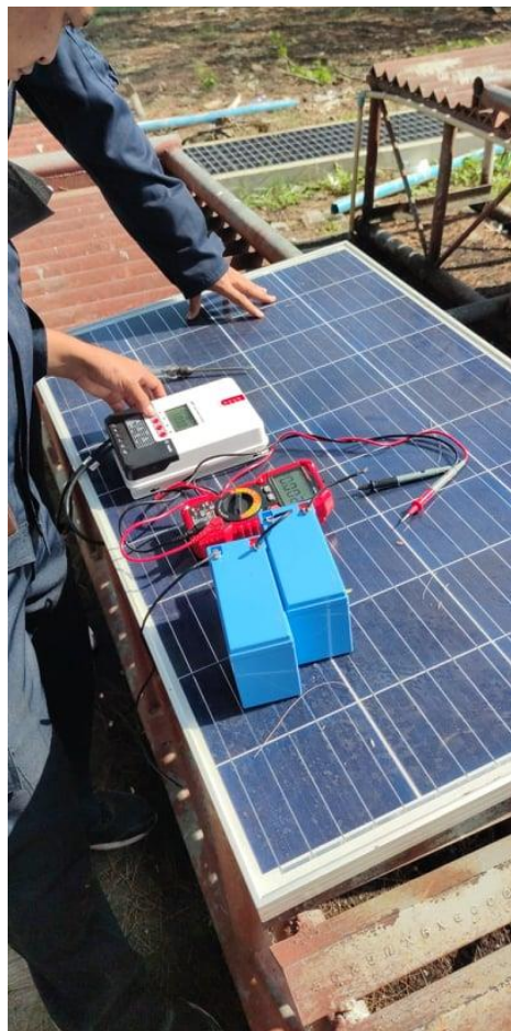
รูปการณ์ทดสอบการชาร์ตแบตเตอรี่จากแผงโซลาร์เซลล์
