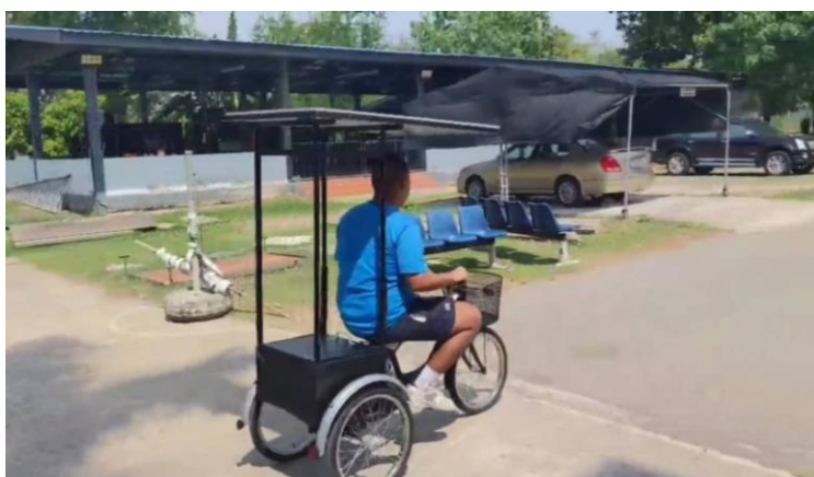
รูปที่ 3.13 ขับขี่ทดสอบรถสามล้อพลังงานแสงอาทิตย์
