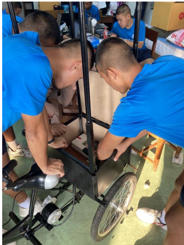
รูปการติดตั้งอุปกรณ์ในตัวรถสามล้อพลังงานแสงอาทิตย์
