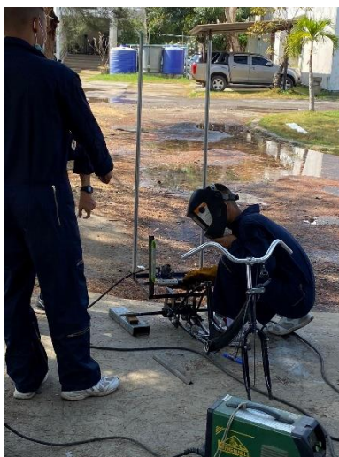
รูปที่ 3.5 นำโครงเสาเหล็กมาเชื่อมกับฐานตัวรถ
