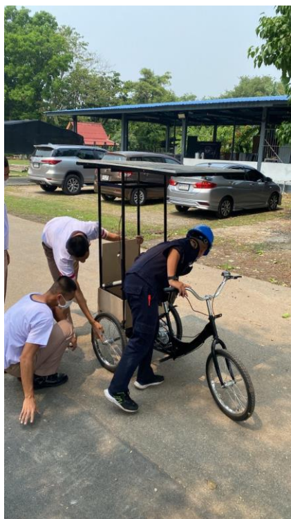
รูปที่ 3.12 ทดสอบการทำงานรถสามล้อพลังงานแสงอาทิตย์
