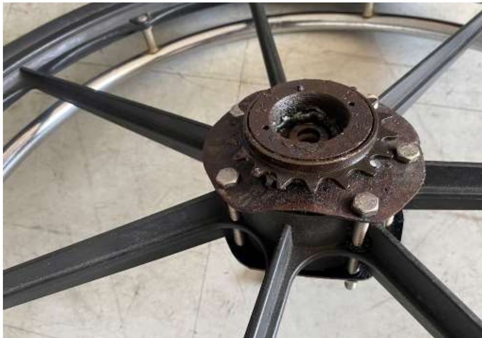
รูปที่ 3.5 การดัดแปลงชุดเฟืองเข้ากับตัวล้อ
