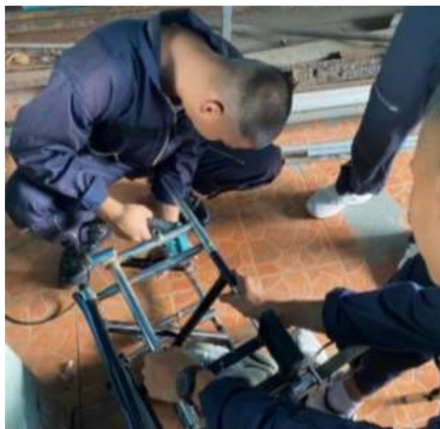
รูปภาพภาคผนวก ข ที่ 4 ตัดแปลงเฟืองจักรยาน
