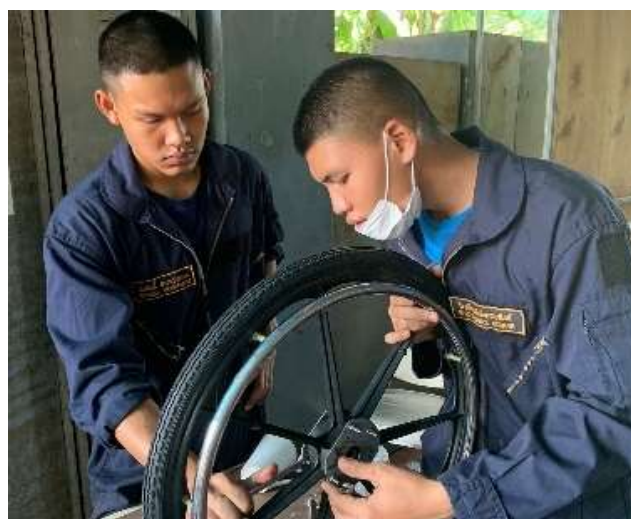
รูปภาพภาคผนวก ข ที่ 3 วัดระยะการติดตั้งเฟืองในตรงกับศูนย์กลางล้อ
