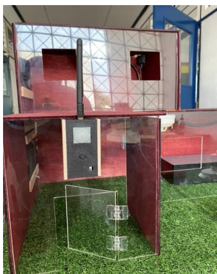
รูปที่ 4.5 การทดลองของโมดูลตรวจจับความเคลื่อนไหวและESP32cam
