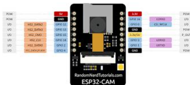
รูปที่ 2.9 แสดงขาของ ESP32cam
