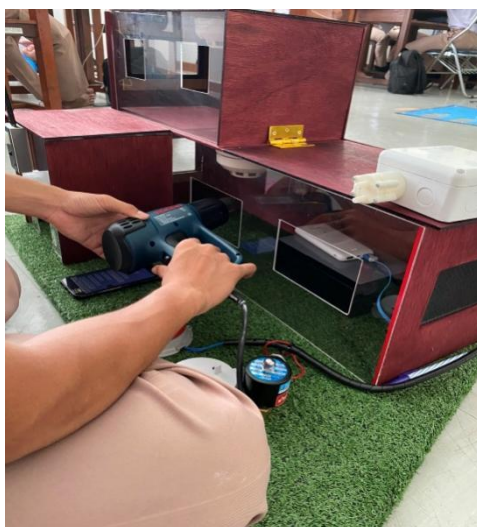
รูปที่ 4.3 การทดลองเซ็นเซอร์วัดอุณหภูมิ DHT11
