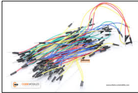
รูปที่ 6 สายจัมเปอร์ (Jumper)
