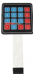
รูปที่ 2.16 4x4 Keypad สำหรับการทดลองใช้งาน
