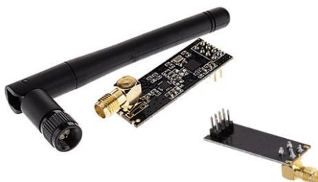
รูปที่ 2.14 เสาส่งสัญญาณขอล Module NRF24L01 ที่มา / https://www.artronshop.co.th/article/44
