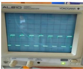
รูปที่ 4.1 สัญญาณขา 3 (Clock)
