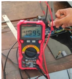
รูปที่ 4.5 การวัดแหล่งจ่ายไฟของบอร์ด Arduino Mega 2560
