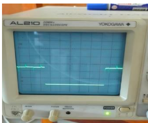
รูปที่ 4.1 สัญญาณขา 3 (Clock)
