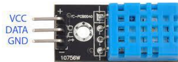
รูปที่ 2.3 ตำแหน่งขาของ Sensor วัดอุณหภูมิ และความชื้น DHT 11
