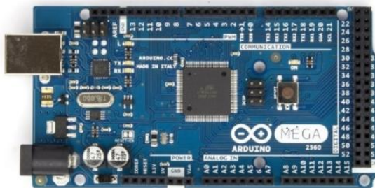
รูปที่ 2.1 Arduino MEGA 2560
