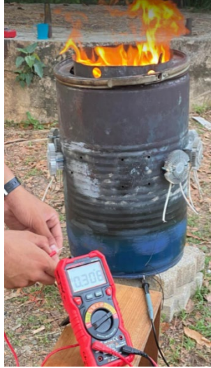
ภาพที่ 3.20 ต่อแผ่นเทอร์โมอิเล็กทริกเข้ากับวงจร DC to DC
