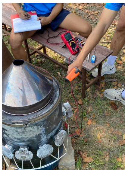
ภาพที่ 2 วัดโวลต์และอุณหภูมิ
