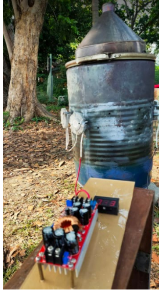
ภาพที่ 5. ต่อเทอร์โมอิเล็กทริกเข้ากับวงจร DC to DC
