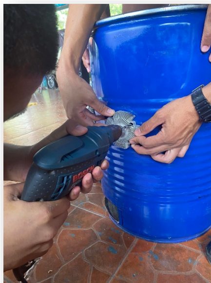
ภาพที่ 3.19 ติดแผ่นเทอร์โมอิเล็กทริกครอบๆถัง
