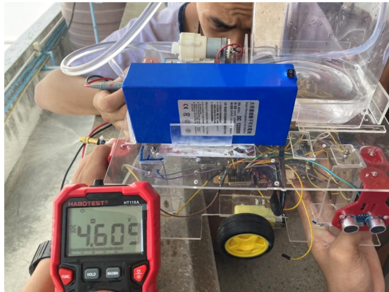
รูปที่ 4.2 การตรวจวัดแรงดันของปั้มน้ำ
