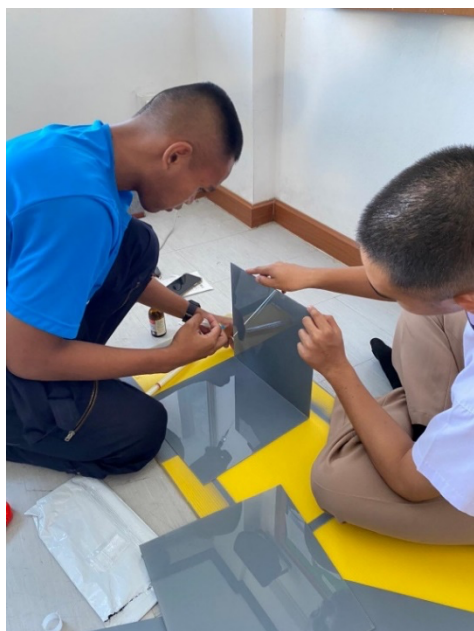
(ง) ประกอบกล่องโดยใช้น้ำยาประสานอะคริลิคติดกับแผ่นอะคริลิค
