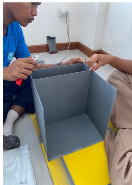
(ง) ประกอบกล่องโดยใช้น้ำยาประสานอะคริลิคติดกับแผ่นอะคริลิค
