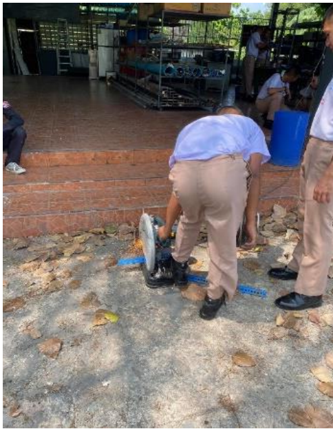
ภาพที่ 3 ตัดเหล็กเพื่อนำไปประกอบเป็น โครงสร้างแบบจำลองลิฟต์
