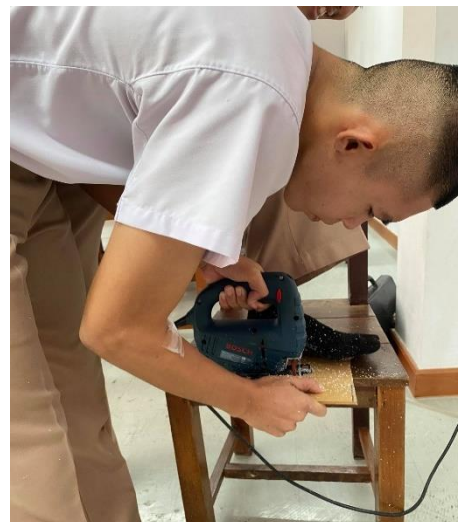
ภาพที่ 6 ตัดแผ่น อะคริลิก เพื่อใช้ในการสร้าง กล่องลิฟต์
