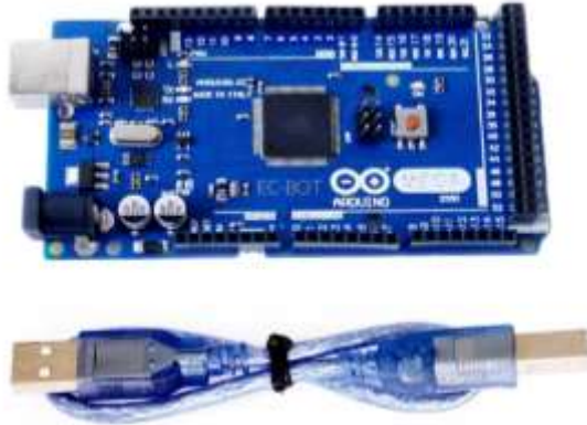
รูปที่ 2.4.1 บอร์ดไมโครคอนโทรลเลอร์ (Arduino Mega 2560)
