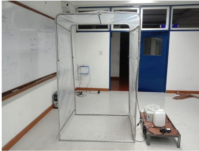
ภาพระบบจ่ายน้ำยาฆ่าเชื้อที่ติดตั้งลงบนแท่นพร้อมระบบตรวจจับและระบบปรับค่าและประมวลผล
