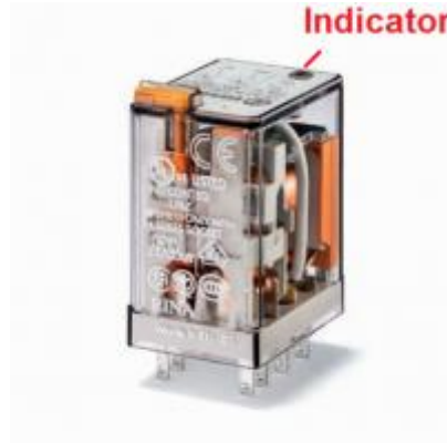
รูปที่ 2.15 ภาพ Indicator แสดงการทำงานของ Relay
