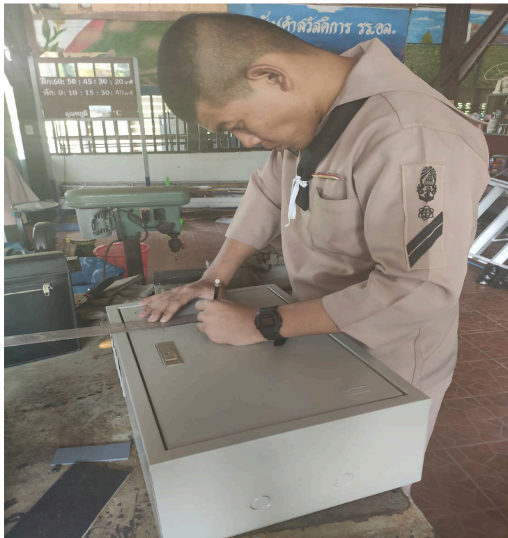
รูปที่ จ - 1 วัดขนาดกล่องควบคุม
