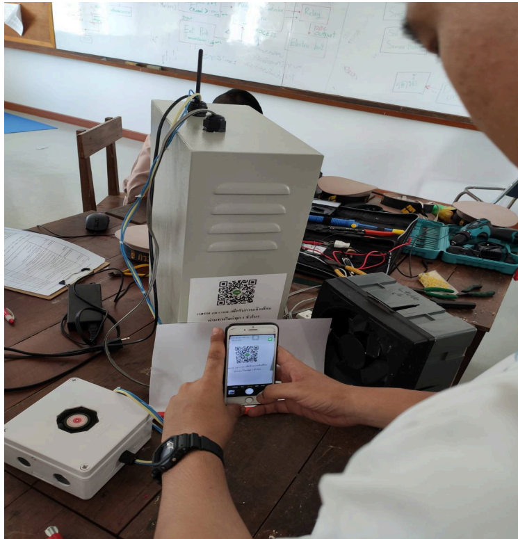
รูปที่ จ - 9 ทดสอบการทำงานบน LINE NOTIFY เข้าผ่าน QR CODE
