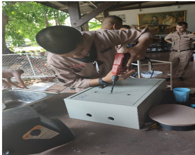
ภาพที่ 3.4.3.2 ทำการเจาะรูเพื่อติดตั้ง Pilot Lamp และ LCD
