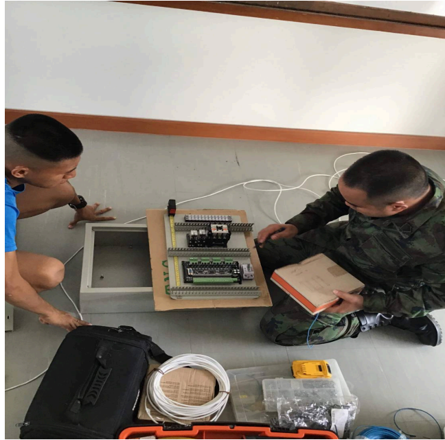
ภาพที่ 3.4.3.4 ทดสอบวงจรระบบแจ้งเตือนและควบคุมเครื่องบำบัดอากาศ PM 2.5
