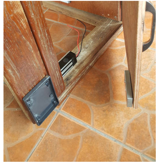
รูปที่ 3.10 Magnetic สำหรับล็อกประตูจำลอง
