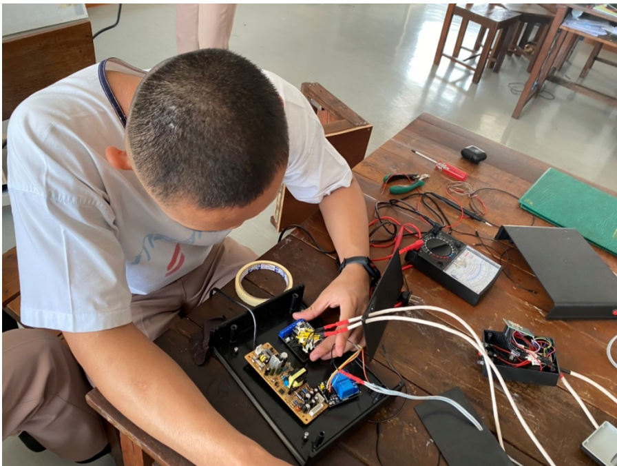
รูปที่ 3.13 การติดตั้งวงจรลงในกล่อง
