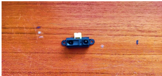
รูปที่ 2.4 GP2Y0A415K Sharp Infrared Sensor
