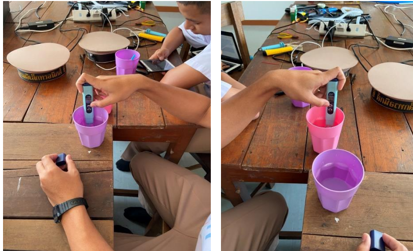
ทดลองวัดค่าน้ำด้วยเครื่อง TDS
