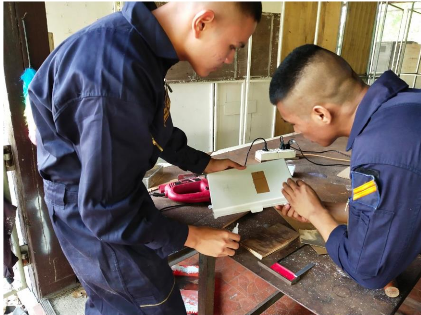
รูปที่ 3.6.4 ติดแผ่นอะคริลิกใสลงบนกล่อง
