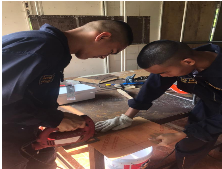
รูปที่ 3.6.3 ตัดแผ่นอะคริลิกใส
