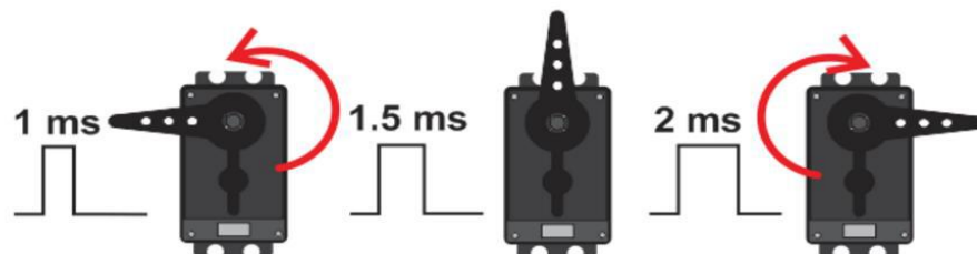
รูปที่ 2.5.5 มุมหรือองศาหมุนขึ้นอยู่กับความกว้างของสัญญาณพัลส์
