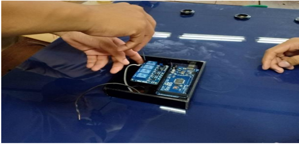
รูปที่ 3.3.5 ต่อวงจรเข้ากับบอร์ดทดลอง
