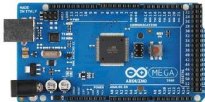
รูปที่ 2.1.1 บอร์ด Arduino mega 2560
