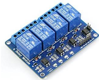
รูปที่ 3.3.3 Relay 4 ch 5v
