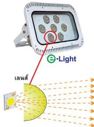
LED แสงพุ่งออกด้านหน้า ควบคุมแสงด้วยเลนส์ ควบคุมแสงใช้งานได้ดี
