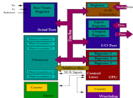
รูปที่ 2.2 หน้าที่ส่วนต่างๆ ของไมโครคอนโทรลเลอร์
