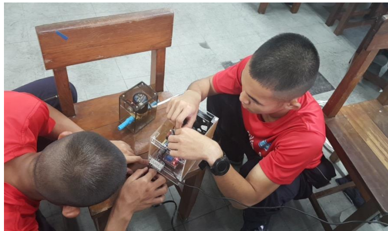
รูปที่ 3.7 ประกอบแผงวงจรเข้ากับกล่องควบคุม
