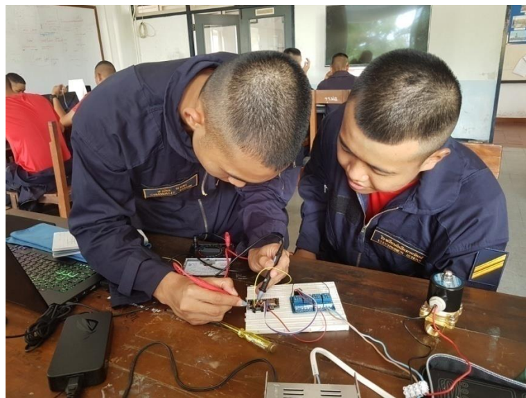
รูปที่ 3.2 วางแผนออกแบบวงจรควบคุมการเปิด-ปิดน้ำ
