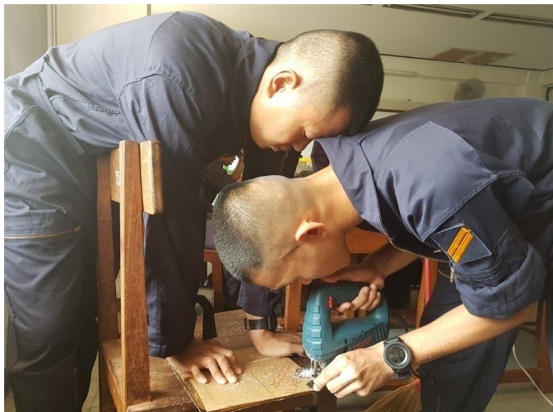
รูปที่ 3.5 ทำกล่องวางวงจรควบคุม
