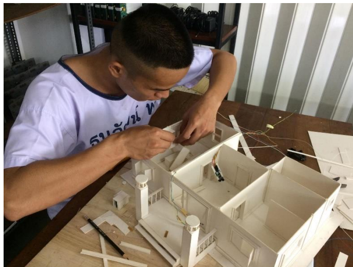
รูปที่ 4.1.1.2 นำเซนเซอร์แต่ละตัวมาติดตั้งภายในโมเดล
