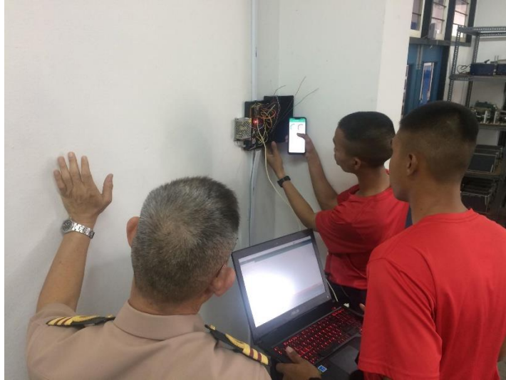
รูปที่ 4.1.2.2 นำโปรแกรมที่ผ่านการทดสอบแล้วอัปโหลดลงบอร์ดภายในกล่องควบคุม
