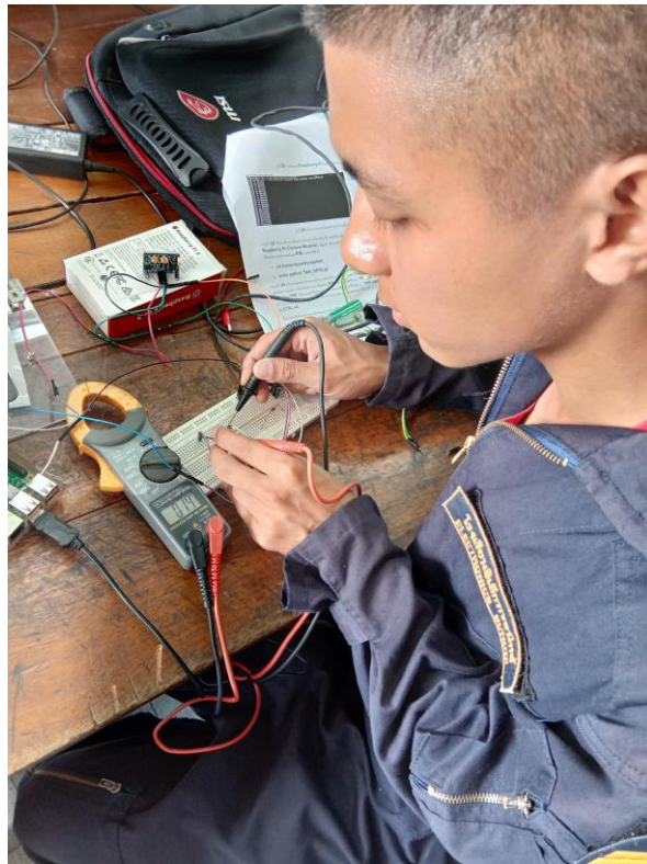
รูปที่ 3.6 ทดสอบการทำงานของ PIR
