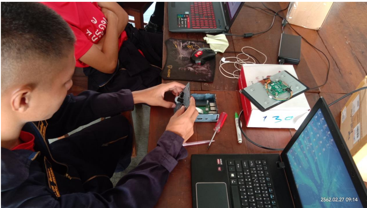
รูปที่ 3.12 ทดลองประกอบฐานยึดบอร์ดกับโครงกล่อง
