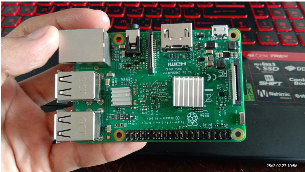
รูปที่ 3.16 ทำการติด heat sink เพื่อเพิ่มประสิทธิภาพในการระบายความร้อน
