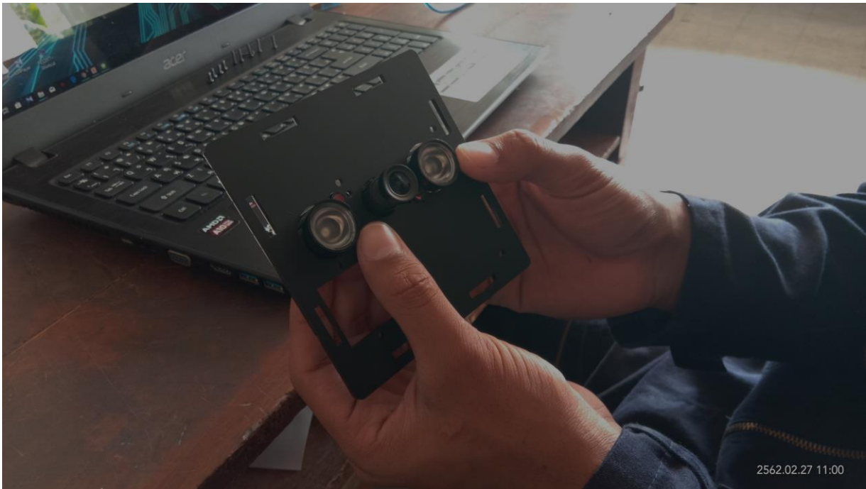
รูปที่ 3.15 ทดลองประกอบกล่องครอบ PIR
