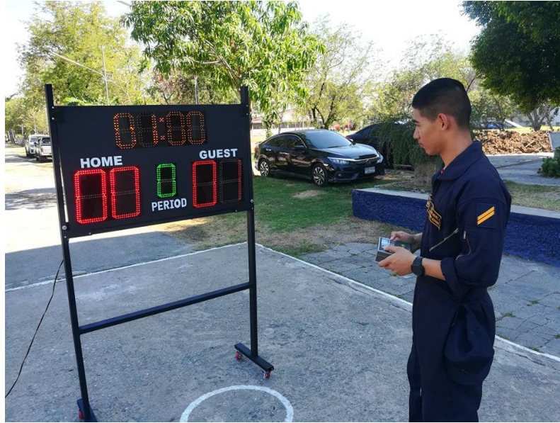
รูปที่ 3.11 ทดสอบการทำงานของรีโมทและสกอร์บอร์ด
